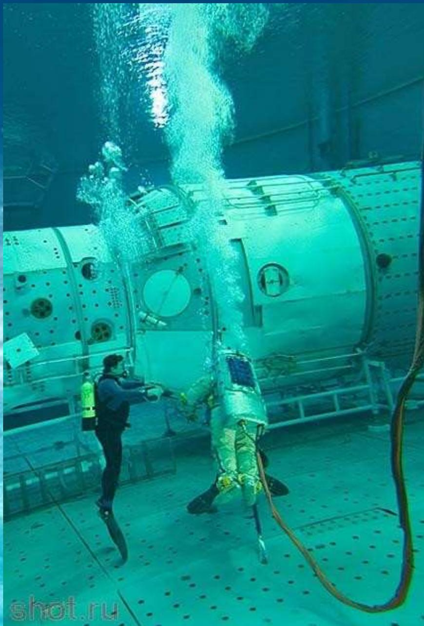
Когда проводятся тренировки под водой, станцию вместе с платформой, подготовливаемыми космонавтами и водолазами опускают под воду, в гидробассейн.
